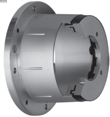
Abb. 4 Monobloc-Pumpenträger, gedämpft, nach VDMA 24 561 Formschlüssige Verbindung ohne Verschraubung Fig. 4 Monobloc-Bell housings with noise damper, acc. to VDMA 24 561 Form fitting without screw joint
